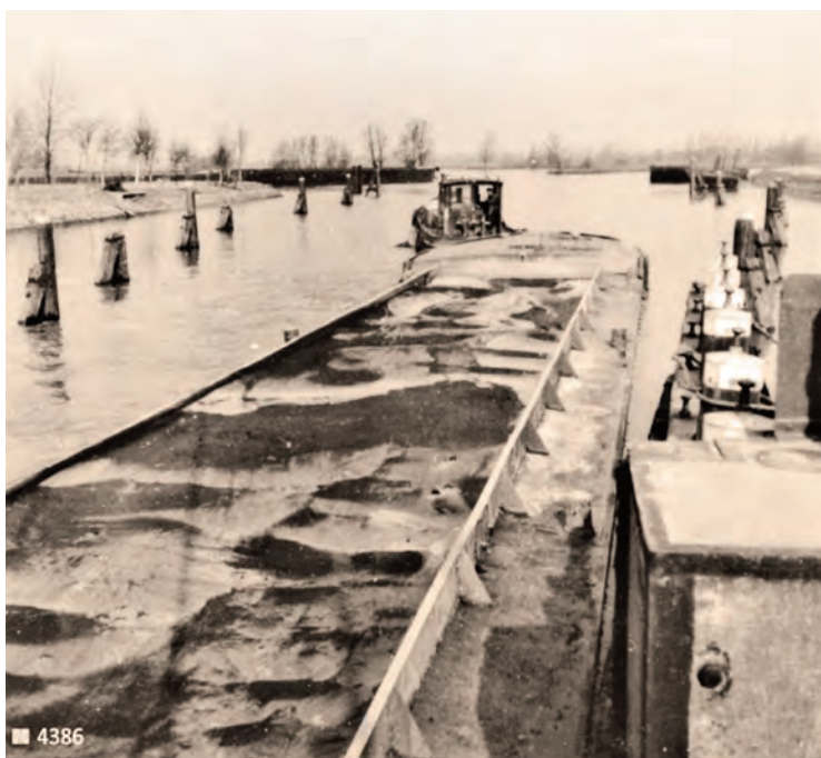
Een uit de Wijde Blik opgehaalde zandbak met een inhoud van 350 kuub zand. De sleepboot trekt hem zo goed als zeker via de Vecht naar het Amsterdam Rijnkanaal om in Amsterdam te worden gelegee
