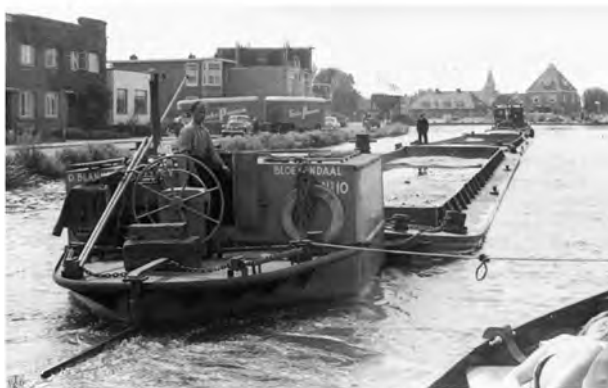
Dit is op de Weespertrekvaart bij Duivendrecht. De bijstuurbak is een welkome hulp om de bakken tijdens het slepen te kunnen bedwingen
